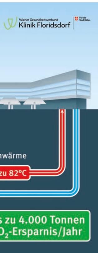
Mit Wärmepumpen werden dem Kühlsystem des Rechenzentrums rund zehn Grad Celsius entzogen, um auf rund 82 Grad Celsius zu kommen. So werden 50 bis 70 Prozent des Wärmebedarfs der Klinik gedeckt.
